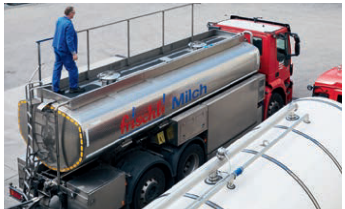
Ein herkömmliches Milchsammelfahrzeug mit dem Aufstieg in 3,40 Meter Höhe und das neue Fahrzeug mit seitlichen Tankdeckeln nebeneinander
