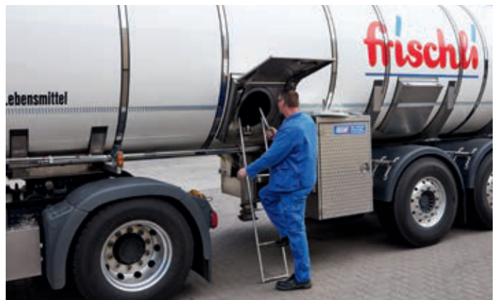
Die Inspektion des Tankinneren sowie der Einstieg in den Tank sind jetzt sicherer als der Einstieg von oben. Für den seitlichen Einstieg steht eine kurze einhängbare Leiter bereit.
