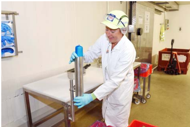
Bild 4: Durch Schwerkraft gleitet die Stange durch das Rohr mit innenliegender Klinge.
