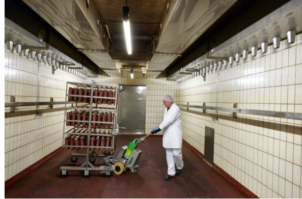
Jetzt: Einsatz der Rauchwagenziehhilfe, die zur Aufnahme unterschiedlicher Wagentypen geeignet ist
